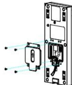
使用 4 颗 M3X4 盘头十字槽机牙螺丝将走线盖固定在设备后盖上。
