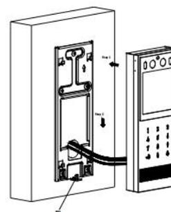
将主机后盖上的四个槽对准挂墙支架上的四个挂钩，保持设备与地面垂直，然后将设备向下压。并且将挂墙支架上的挂钉插入设备下方的孔位，听到“咔”一声，则设备安装完成。
