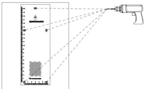
将安装定位贴纸贴在墙上，根据贴纸上的孔位，使用直径为 6 毫米的电钻在墙上钻 5 个深度为 20 毫米的安装孔。
