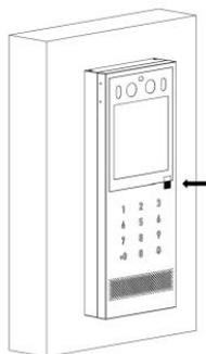
检查设备四周的缝隙是否过大，从底部向上推设备以确认是否安装牢固。确认后，即可撕下设备保护膜。
