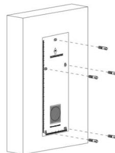
将 5 颗膨胀栓敲入安装孔位。
