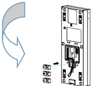
选择合适的压线密封塞，撕下密封塞背面的离型纸，将密封塞贴在对应位置（见图）。连接线缆至主板上的相应位置。
