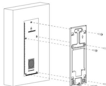
将挂墙支架与安装定位贴纸对齐，并使用 5 颗 ST4x20 盘头十字槽自攻螺丝将挂墙支架锁紧在墙上，使挂墙支架与墙面贴合。
