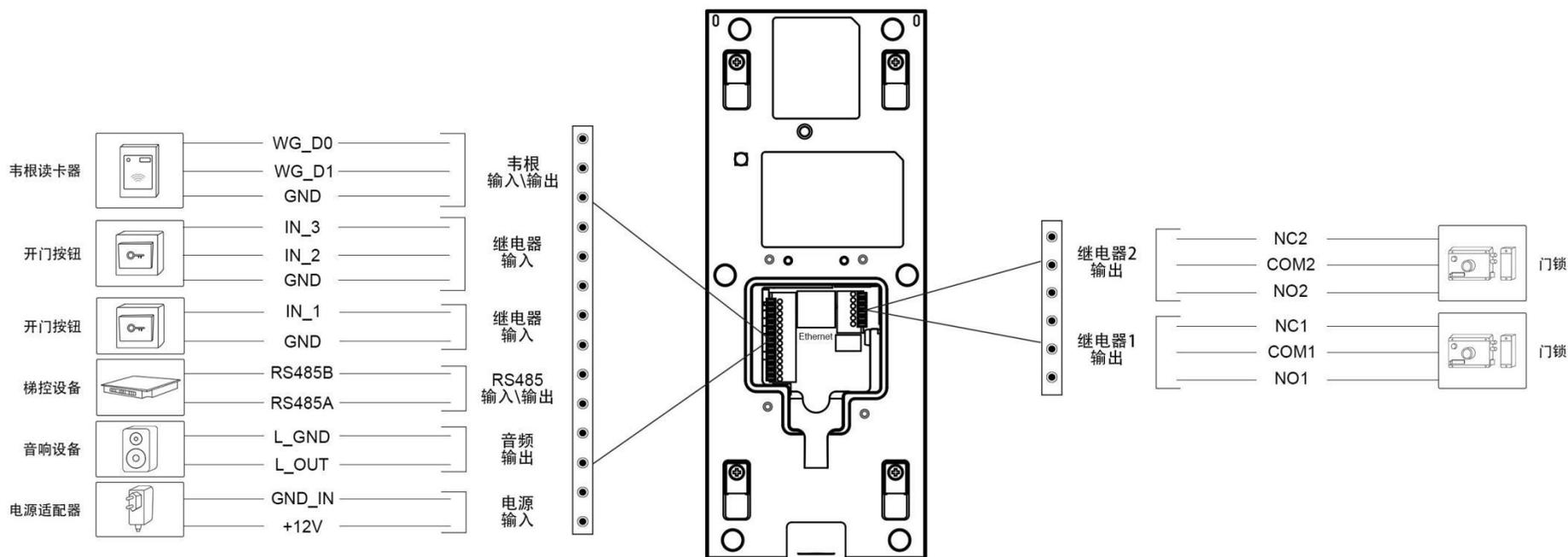
警告：当您使用继电器接口连接包含电感线圈的设备（如电磁锁）时，为了减少在断开电感线圈负载时有可能出现的峰值电压对设备的影响，我们建议将二极管（1A/200V）反向并联到电感线圈负载的两端。
