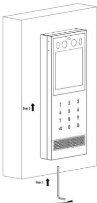
如图所示，将内六角扳手插入设备底部左侧的孔中，顺时针旋转 90°，再将设备向上推直至设备脱离挂墙支架。
