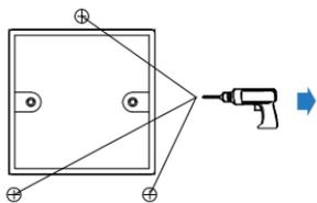
取下挂墙支架,并使用6mm电钻在已标记位置钻孔(孔的深度约为25mm)。
