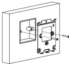
将2颗M4x30盘头十字槽机牙螺丝从挂墙支架上拧下。
