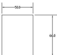
根据位置墙上的电缆位置，挖出一个可以容纳所有电缆的方孔(方孔尺寸为高\*宽\*深=66\*50\*50mm)。
