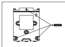
将挂墙支架上的方孔对齐墙上挖的孔，然后使用记号笔对着挂墙支架三个孔位做标记。
