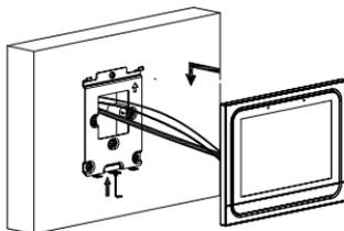
使设备背面的两个方孔悬挂在挂墙支架的两个挂钩上,并使设备与墙面始终保持平行直至将设备底部的M3x6紧固螺丝拧紧。
