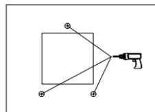
取下挂墙支架，并使用6mm电钻在已标记位置钻孔(孔的深度约为25mm)。
