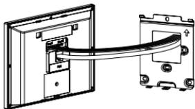
将网线和信号电缆连接到设备背面的相应接口。
