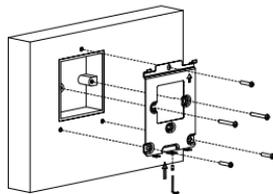
使用内六角扳手将M3x6紧固螺丝拧入支架底部,直至其尾部与支架齐平。然后用3颗ST4x20盘头十字槽尖尾自攻螺丝和2颗M4x30盘头十字槽机牙螺丝固定挂墙支架。
