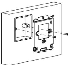
使用2颗M4x30盘头十字槽机牙螺丝将挂墙支架挂在86盒内。
