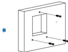
然后将3颗膨胀栓敲入钻好的孔位。
