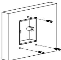
然后将3颗膨胀栓敲入钻好的孔位。
