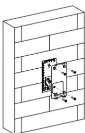
使用四颗ST4X20沉头十字槽自攻螺丝锁紧膨胀栓，将挂墙支架固定在墙上。
