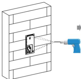
根据墙上预留的线缆位置，将安装定位贴纸贴在墙上，请确保预留线缆能够穿过贴纸阴影部分。然后使用6mm钻孔机在贴纸的孔位钻4个深度为25mm的孔。
