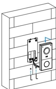
将设备悬挂在挂墙支架的两个挂钩上，然后使用附带的T10梅花带孔扳手用两颗M3x6沉头梅花带柱机牙螺丝锁紧设备底部。
