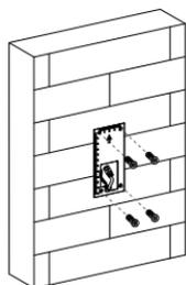
将4颗膨胀栓敲入钻好的孔位。
