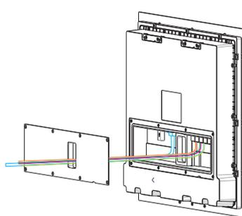
将电缆穿过压线盖，并连接至主板的相应接口。
