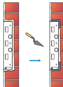
用水泥或无腐蚀性的结构胶粘剂填充墙体与预埋盒之间的空隙。等待粘合剂材料干燥，然后进行下一步。
