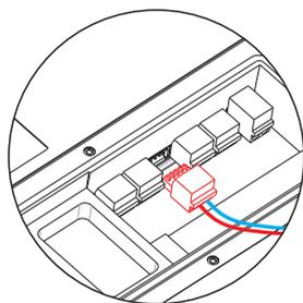
将所需要的电缆线与连接器连接，然后将2PIN以及5PIN接线端子插入设备上相应的位置。2PIN接线端子用于连接电源，其余的连线您可以参考设备接线部分。
