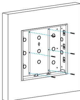
将预埋盒放入方孔中，直至方孔边缘与墙面对齐且所有线缆均穿过方孔。然后用6颗ST4x20盘头十字自攻螺钉固定预埋盒。
