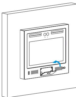
取出一片刷卡装饰板，将刷卡装饰板下边缘对准主机刷卡区域下缘（注意：刷装饰板上的圆孔要在左上角方向）。然后盖上刷卡装饰板，按压刷卡装饰板四周，使刷卡装饰板卡扣卡入设备面板。
