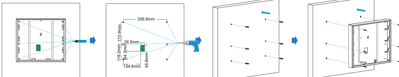
将挂墙盒背部贴紧墙壁, 绿色开口处为墙上出线位置。结合这一步和下一步的示意图, 确保挂墙盒和墙上出线孔的相对位置完全正确。使用记号笔对着挂墙盒边缘六个孔的中心位置在墙壁上做记号, 记号尽量在标记孔的中心。图中绿色部分是接口处。
