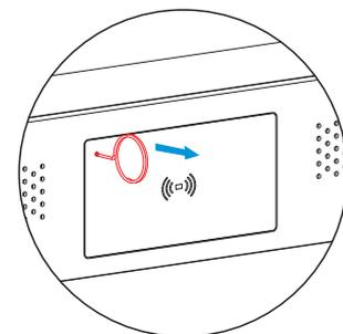
如果需要拆解，请使用附带的拆装钥匙，伸入刷卡装饰板左上角的圆孔，拉动即可取下刷卡装饰板。
