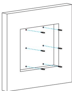
将膨胀管敲入钻好的孔位。
