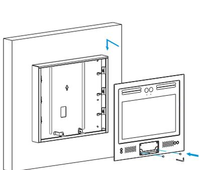
将主机装入挂墙/埋墙盒，并下压。注意主机背面的6个挂钉要钩住挂墙盒的挂孔。用附赠的T10梅花带孔扳手锁紧下方两个M3x8盘头梅花带柱机牙螺丝。
