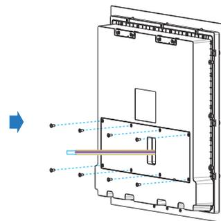
用8个M3x4沉头十字槽机牙螺丝锁紧接压线盖。
