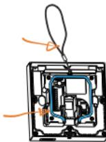
为方便安装,请将挂绳穿过设备背面的绳孔,然后用硅胶密封条将凹槽填满。
