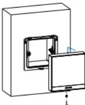
如图所示,将设备平推下压(压入挂钩),并使用内六角扳手 将M3×4紧定螺丝拧入设备下方,以锁紧设备。
