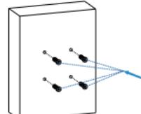
先用4颗ST4×20盘头十字槽尖尾自攻螺丝将86盒固定在墙上，再用2颗M4×30盘头十字槽机牙螺丝将挂墙板在86盒上。
