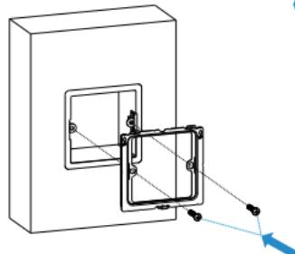
使用2颗M4×30盘头十字槽机牙螺丝将挂墙板固定在86盒上。
