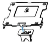
如图所示,将压线密封塞放进防水压片相应的口。
