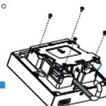
用4颗M2.5×4盘头十字槽机牙螺丝将防水压片固定在设备上。
