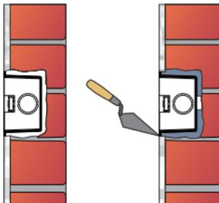
根据线缆位置,在墙上挖出一个方孔(方孔尺寸为86\*86\*33毫米),然后使所有线缆穿过86盒。
